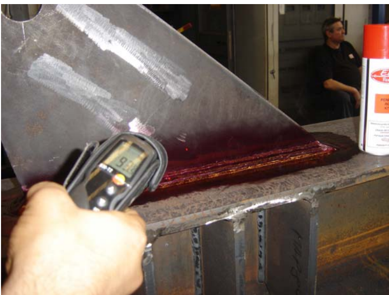
Fig.2 Elite K71B2p su saldatura a 93,5°C
